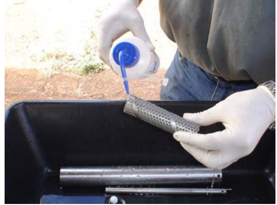
Foto 19 – Circulação de água deionizada em peça da bomba de bexiga
