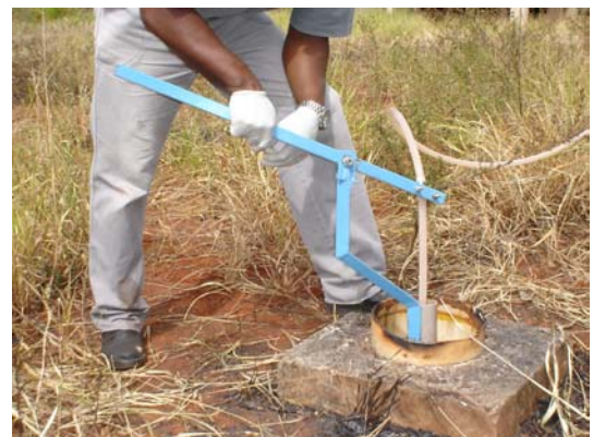
Foto 08 – Purga dos poços com auxílio de dispositivo
