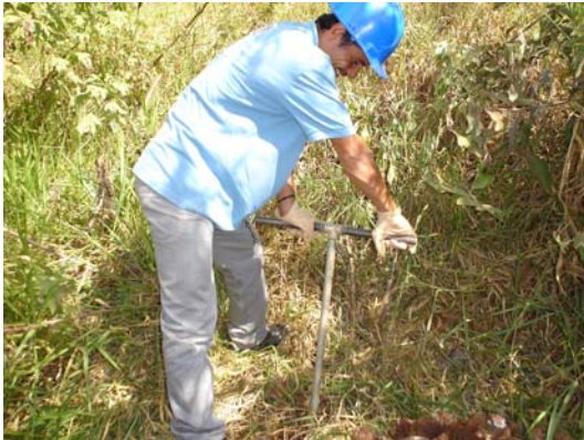
Foto 01 – Sondagem a trado manual
