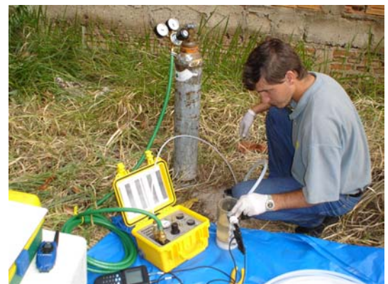
Foto 15 – Conjunto de amostragem com controlador e cilindro de gás
