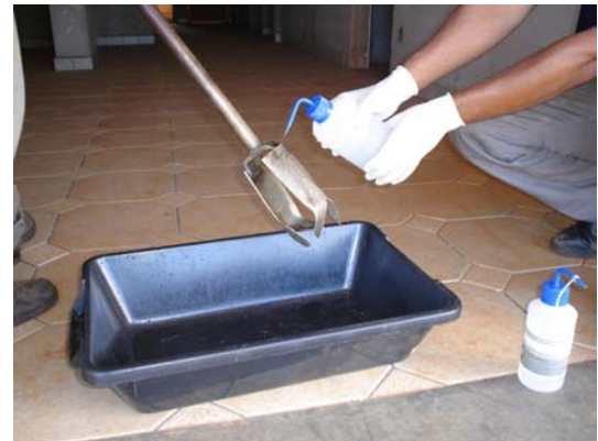
Foto 21 – Esterilização do equipamento de sondagem
