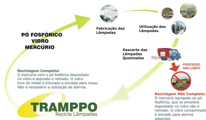
Fonte: NERY, Roberson, 2008. A figura ilustra o processo adequado de reciclagem de lâmpadas mercuriais.
