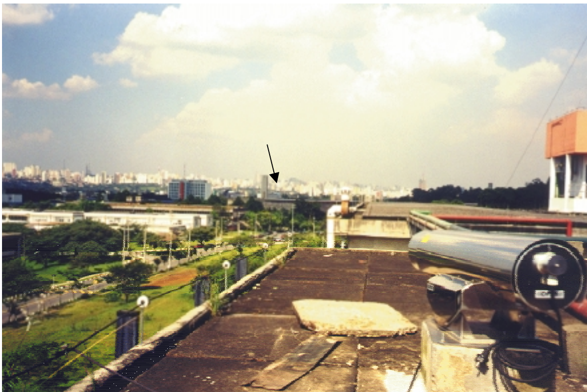
Figura II.11 : Foto do receptor do DOAS em primeiro plano, no prédio do Instituto de Física – USP, e fonte de luz, emissor indicado pela seta localizado no Instituto de Matemática.
